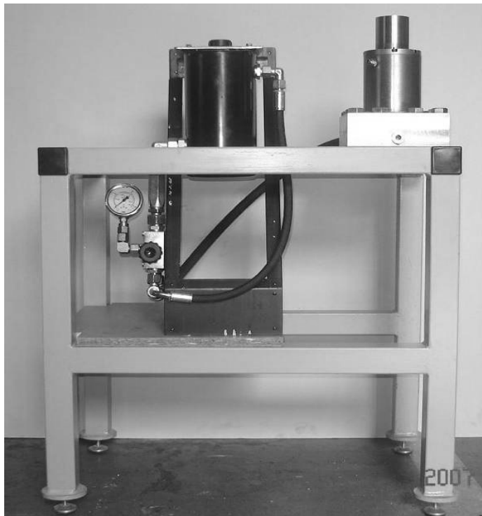
Rys. 2. Przyrząd ciśnieniowy PC-1 do modyfikacji warstwy wierzchniej tulei
