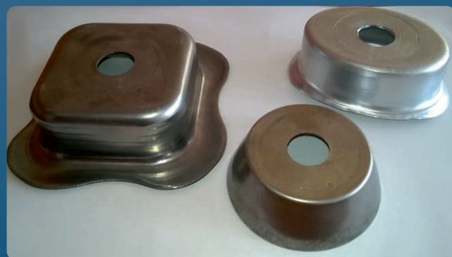
Rys. 6. Przykłady wyrobów wykonanych na wyoblarce specjalnej MWS-200
