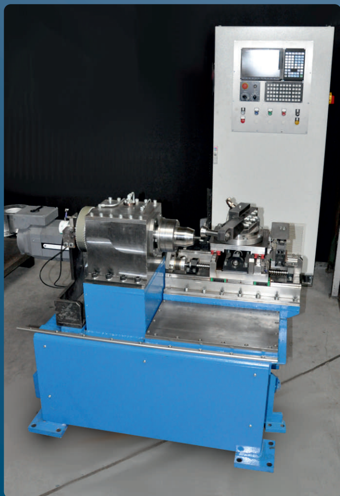
Rys. 1. Wyoblarka MWS-200 do kształtowania wyrobów osiowo niesymetrycznych ze zdjętą osłoną oraz z szafą z zasilaniem i sterownikiem CNC
