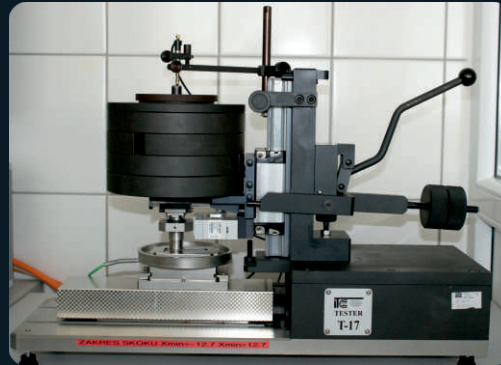
Tester tribologiczny T-17 The T-17 tribometer
