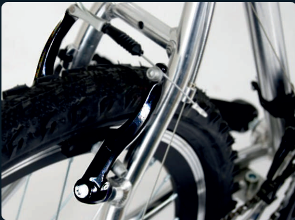
Zastosowanie szczęki hamulca typu V-Brake Application: jaws of V-Brake
