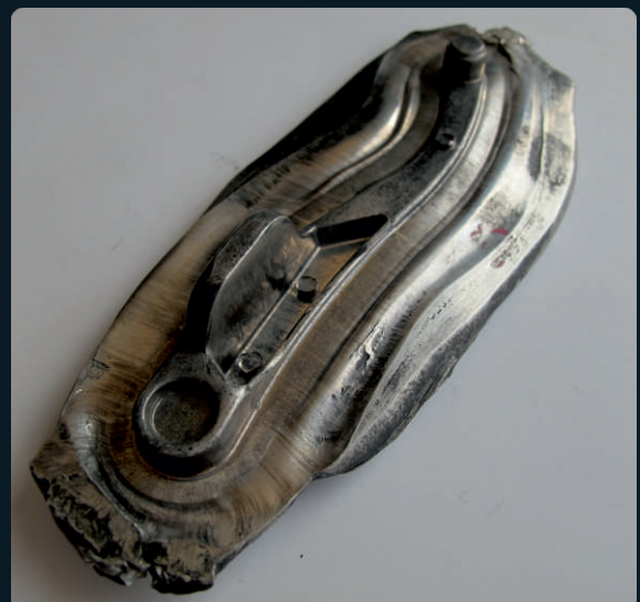
Odkuwka szczęki hamulca z AZ91 wykonana w procesie kucia AZ91 brake jaw made in a process of forging
