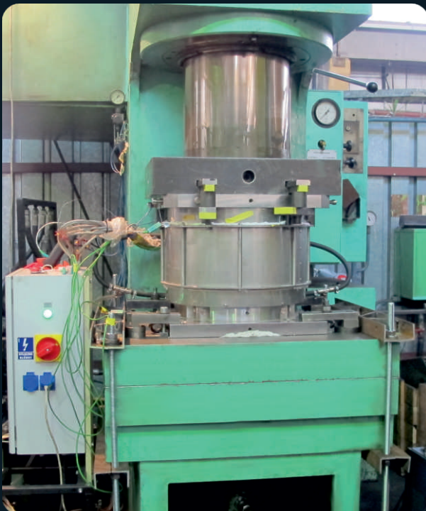
Stanowisko badawcze z narzędziem do kucia izotermicznego Test stand with a tool for isothermal forging
